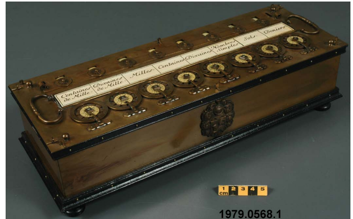
Abb. 2: Nachbau der Pascaline von Roberto Guatelli 2. Von Blaise Pascal sind acht Originalmaschinen erhalten. Sie befinden sich u.a. in Paris, Clermont-Ferrand, Dresden und New York. Pascal baute die erste Maschine 1642 (© Canada Science and Technology Museum, Ottawa, Objekt Nummer 1979.0568.001).
