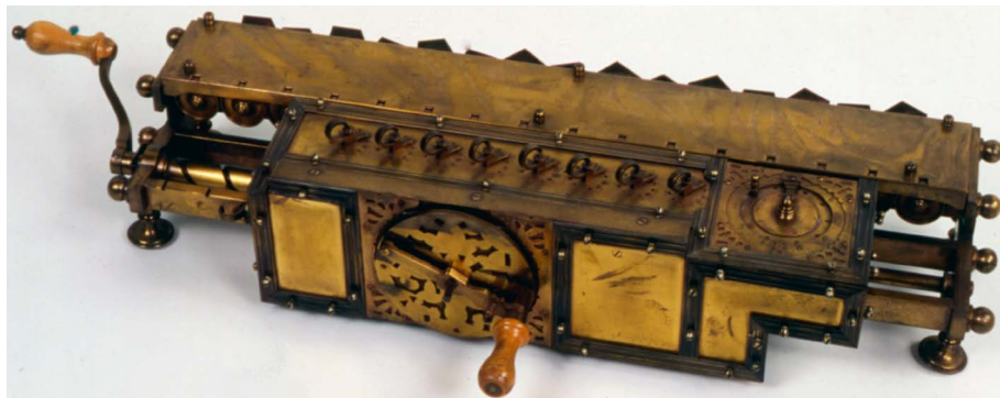
Abb. 3: Nachbau der Leibniz-Rechenmaschine von Roberto Guatelli. Gottfried Wilhelm Leibniz (1646–1716) baute seine erste Rechenmaschine 1673. Das einzige erhaltene Exemplar stammt aus den 1690er-Jahren und wird in Hannover verwahrt. Es ist die weltweit erste mechanische Rechenmaschine, die alle vier Grundrechenarten beherrscht (© Museo nazionale della scienza e della tecnologia «Leonardo da Vinci», Mailand).
