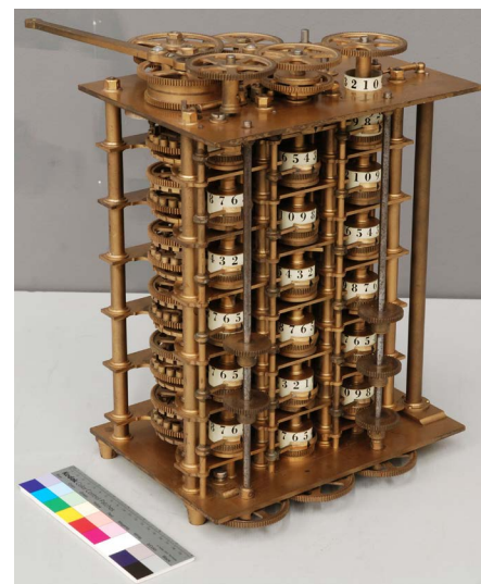
Abb. 4: Nachbau der Babbage-Differenzmaschine von Roberto Guatelli. Charles Babbage (1792–1871) arbeitete ab 1822 an seiner ersten Differenzmaschine, die jedoch unvollendet blieb. Sie sollte die fehlerfreie Erstellung mathematischer Tafelwerke ermöglichen. Die Maschine befindet sich in London (© Canada Science and Technology Museum, Ottawa, Objektnummer 2011.0022.001).
