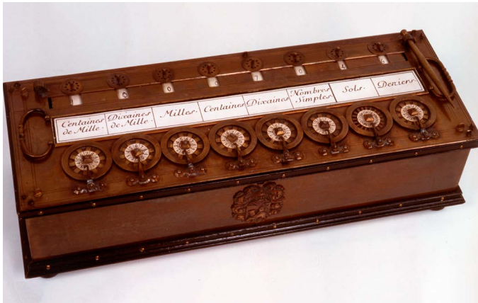
Abb. 1: Nachbau der Pascaline von Roberto Guatelli 1. Die Addier- und Subtrahiermaschine von Blaise Pascal (1623–1662) kann Werte bis 999 999 livres darstellen. 1 livre hat 20 sols, 1 sol 12 deniers (© Museo nazionale della scienza e della tecnologia «Leonardo da Vinci», Mailand).
