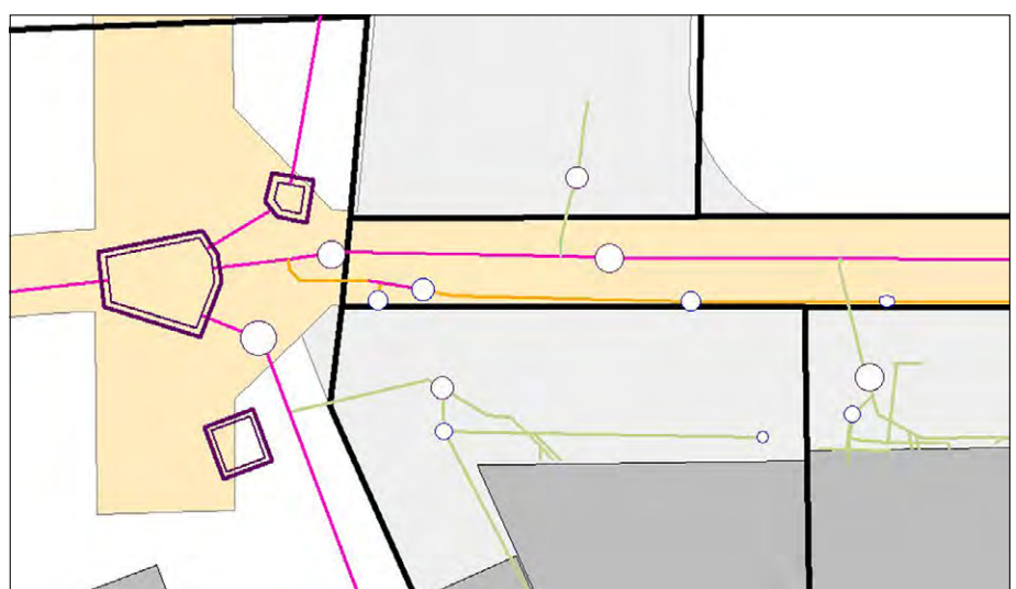
Fig. 5: Canal de collecte (rose) situé entre deux canaux de drainage routier (orange).
