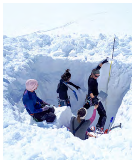
Abb. 2: Schneeschacht, 3 m tief, nahe des Jungfrauochs. Alle 20 cm wurden Schneedichte und Temperatur bestimmt. Dies ist im Vergleich zu den Bohrungen viel aufwändiger, jedoch lassen sich Schichten im Schnee besser identifizieren (Foto: M. Zemp).
